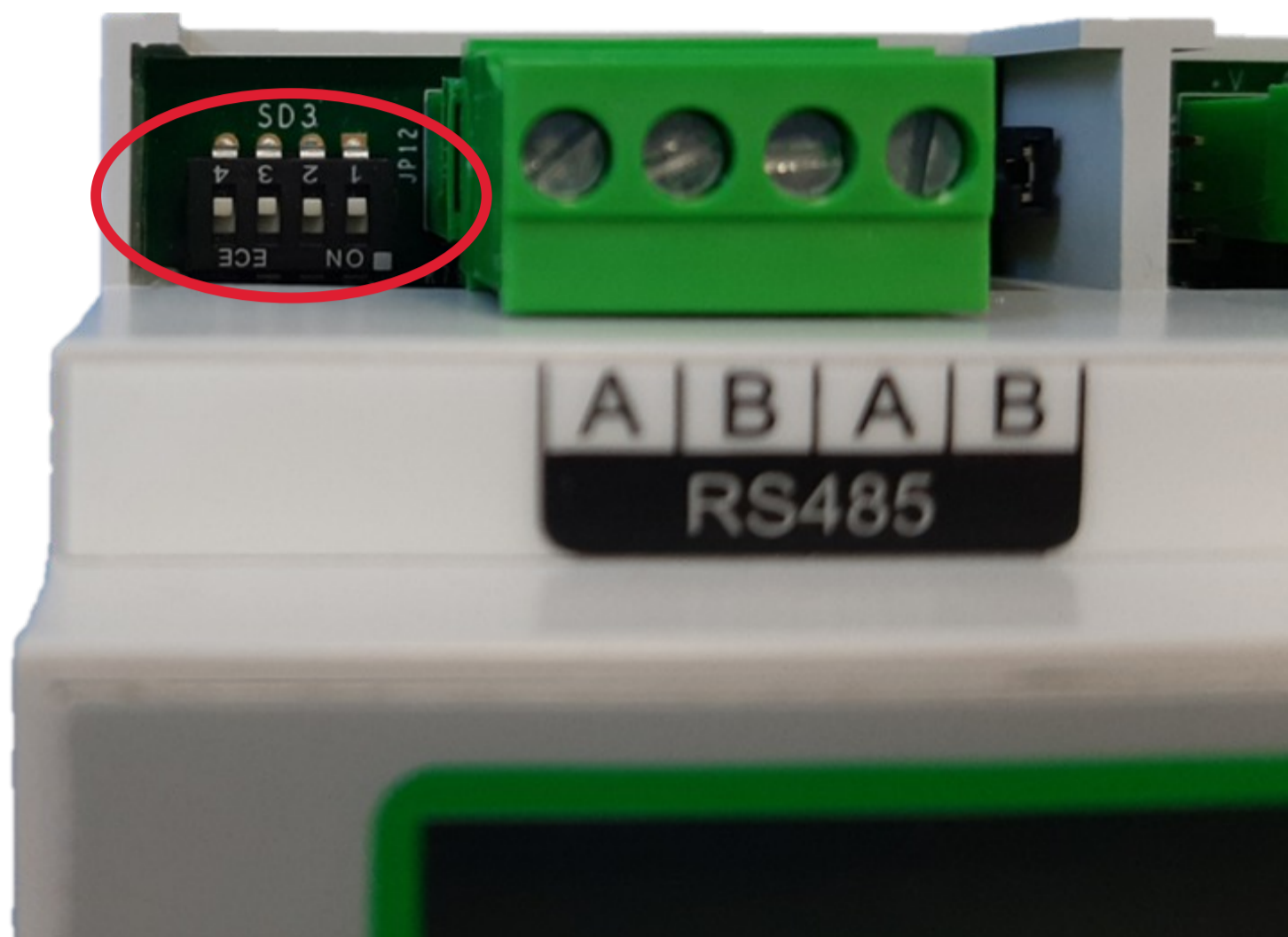
Figura 8) Serie di dip switch per l'impostazione della lingua
